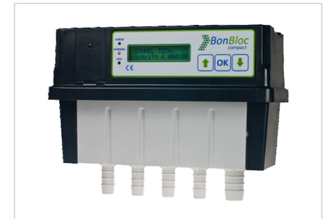
Sterownik BonBloc łączy oba elementy: sterownik i blok zaworów w jedno kompaktowe, łatwe do zainstalowania urządzenie. Zamiast konwencjonalnych zaworów elektromagnetycznych wykorzystano silniki krokowe znane z przemysłu motoryzacyjnego. Zawory te są – za sprawą łagodnego i powolnego ruchu – dużo cichsze od standardowych zaworów elektromagnetycznych.
