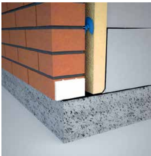
Rys. 69. Zastosowanie puszki wentylacyjno-odwadniającej
