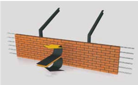
Rys. 38. Parcie i ssanie wiatru
