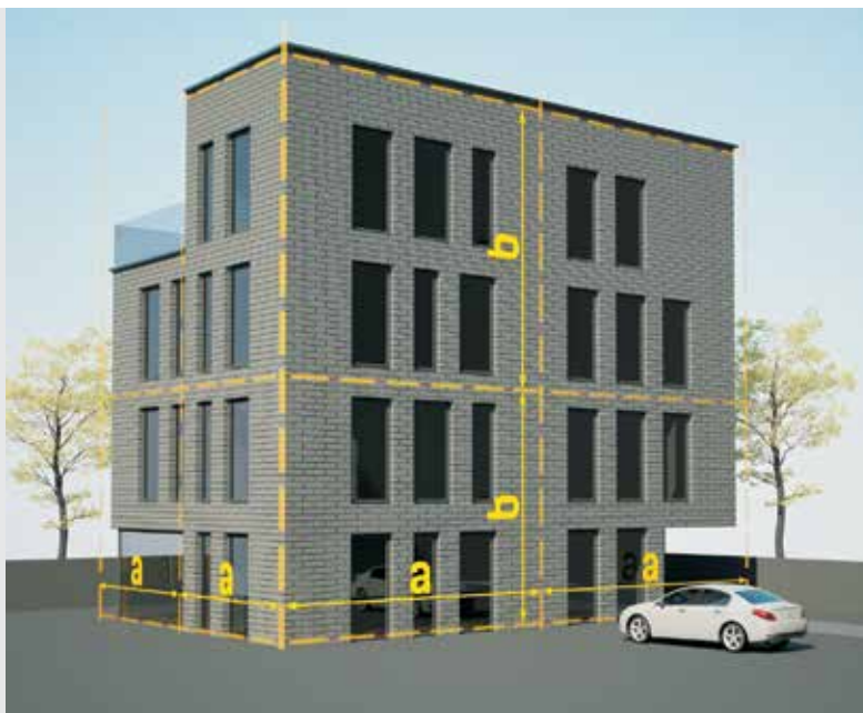
Rys. 49. Przykładowe rozmieszczenie dylatacji budynku
