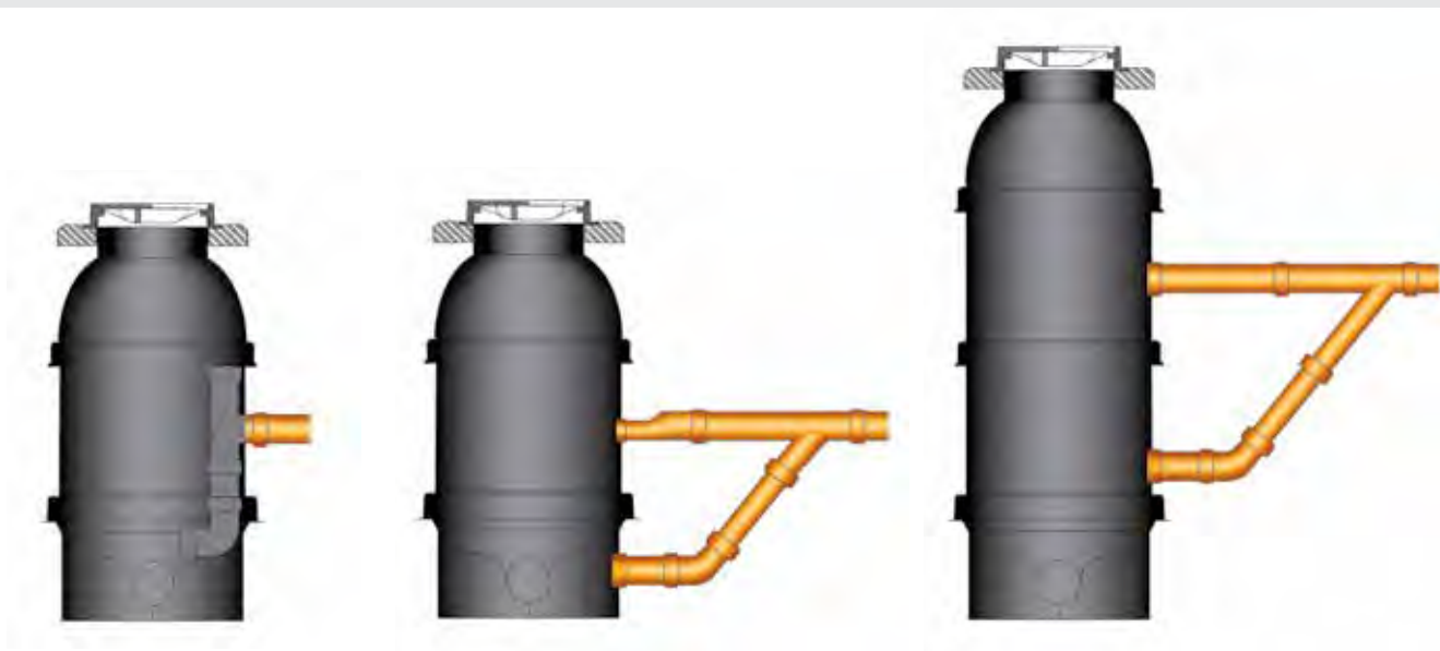
Przykładowe rozwiązanie kaskad przy studzienkach włączowych
