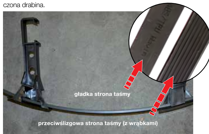
Rys. 4. Szczegół – usytuowanie wsporników drabinki na taśmie. Przeciwsłizgowa strona taśmy (od strony rury karbowanej), gładka strona taśmy (od wnętrza studzienki)
